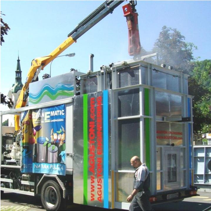
Comincia il procedimento di lavaggio, pulizia, disinfezione con il sollevamento di un elemento estensore che copre totalmente il contenitore prima della fase del lavaggio.
